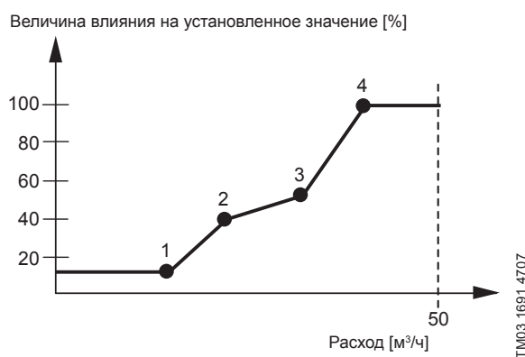
Рис. 47 Соотношение между влиянием на установленное значение и расходом
